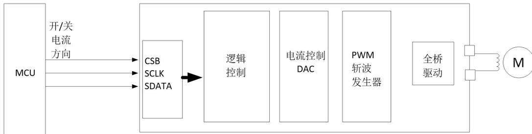
混合控制模式：通过 SPI 设置电流大小，INxA/B 控制输入的状态和方向。
